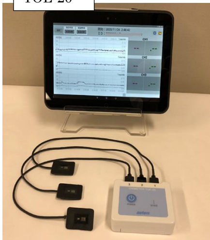
(図1) 今回開発した TOE-20 (図2) TOE-20 のセンサープローブを足の動脈支配領域ごとに貼付した図 (特許出願 PCT/JP2020/39614)
