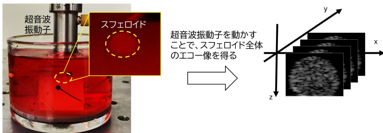
図1 計測システムの外観。培養したスフェロイドを培地で満たした水槽中に置き、超音波プローブを水槽内で動かすだけでスフェロイド全体のエコー像が得られる。図は（Ito et al., npj Biomed. Innov. 2025）を改変。
