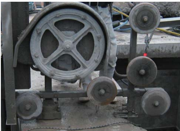
切断準備中のダイヤモンドワイヤーソー
