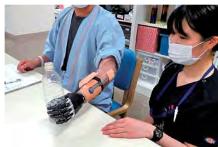
図3 上肢切断者の筋電義手(松本義肢製作所)
