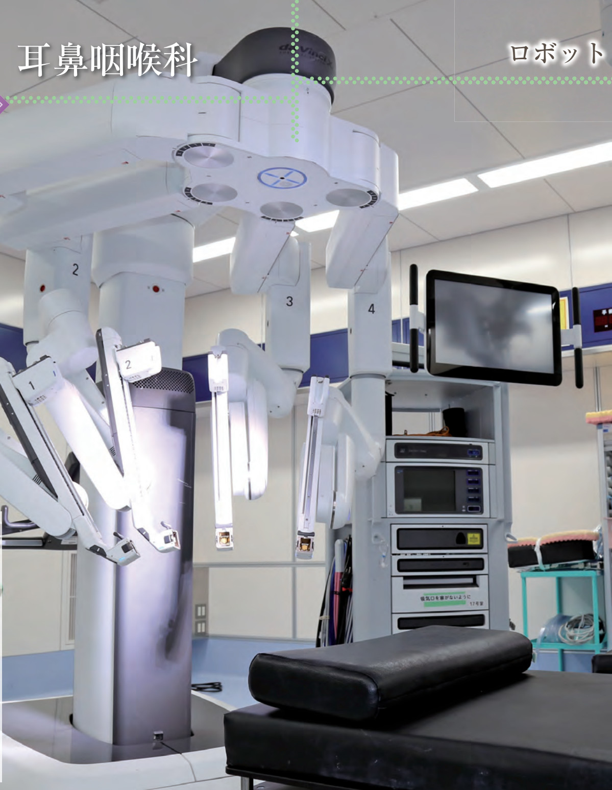
アームに内視鏡や鉗子を装着し、人間の手首以上に自由自在な動きでの手術が可能。低侵襲で体に負担の少ない手術を実現します。
