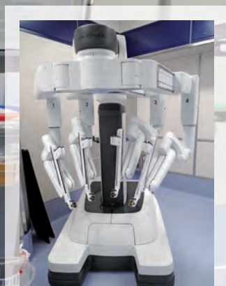
アームに内視鏡や鉗子を装着し、人間の手首以上に自由自在な動きでの手術が可能。低侵襲で体に負担の少ない手術を実現します。
