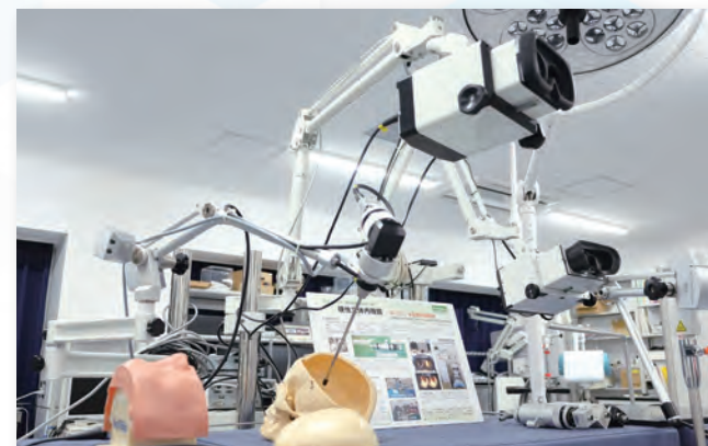
▲ 顕微鏡の操作感覚で使用できる手術用立体内視鏡
