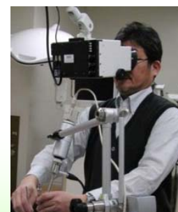
ロボットアームの遠隔操作
